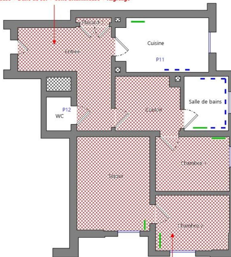
**a P010 Colle non bitumineuse + Dalle de sol + Colle bitumineuse + Ragréage**
